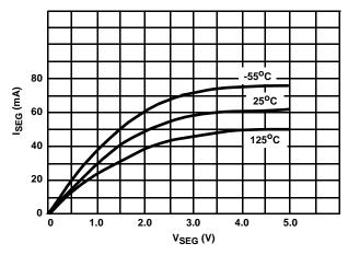
FIGURE 6. COMMON ANODE SEGMENT DRIVER I<sub>SEG</sub> vs V<sub>SEG</sub>
